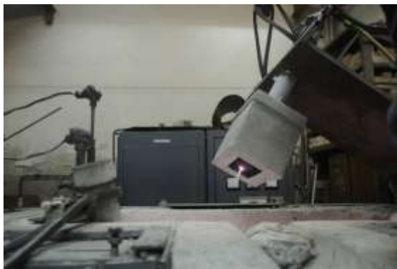
Робота плазмотрону з випарною реакційною камерою в холостому режимі (ліворуч) та процес МГД-плазмової обробки рідкого алюмінієвого сплаву А390 в ливарній магнітодинамічній установці (праворуч)
