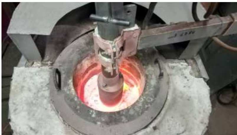
Плазмотрон (ліворуч) та глибинна плазмове рафінуюча обробка алюмінієвого розплаву (праворуч)
