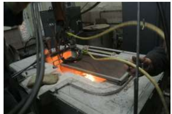
Робота плазмотрону з випарною реакційною камерою в холостому режимі (ліворуч) та процес МГД-плазмової обробки рідкого алюмінієвого сплаву А390 в ливарній магнітодинамічній установці (праворуч)
